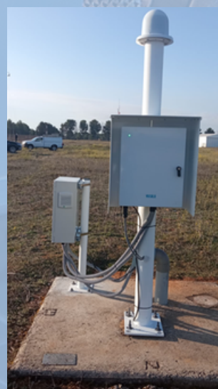
Fig. 5.1 - Nuevo detector de rayos en la base de las FAMET en Almagro
