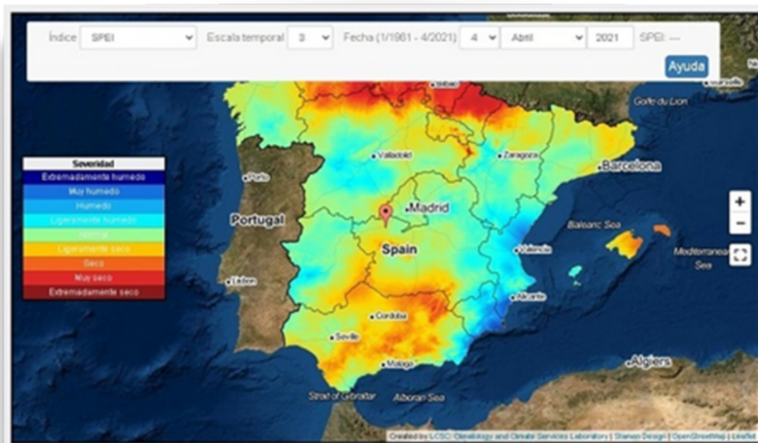
Fig. 5.15 – Monitor de sequía meteorológica, que suministra información en tiempo real a partir de las estaciones meteorológicas automáticas de la red de AEMET y del SIAR
