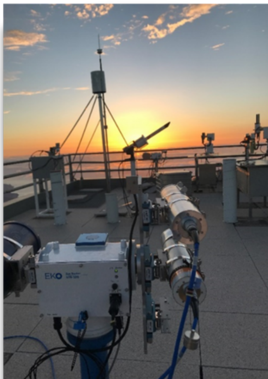
Fig. 6.3 - Atardecer desde la terraza de observación del Observatorio de Izaña durante la campaña EMPIR-MAPP. En primer plano aparecen los radiómetros PFR (Precision Filter Radiometer) y el espectrorradiómetro PSR (Precision SpectroRadiometer) del World Radiometric Center, y al fondo se ven espectrómetros y radiómetros
