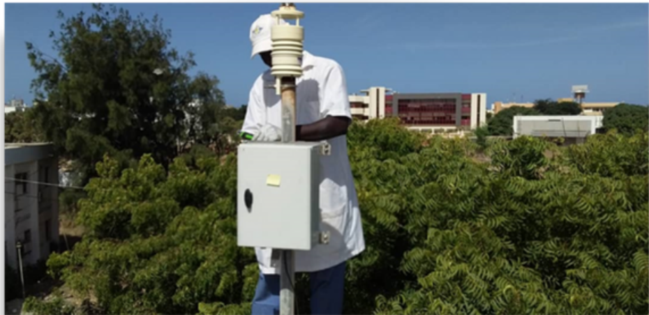
Fig. 6.5 - Sensor de material particulado instalado por el técnico de la Agencia Nacional de la Aviación Civil y la Meteorología de Senegal, como parte del proyecto MacClima.
